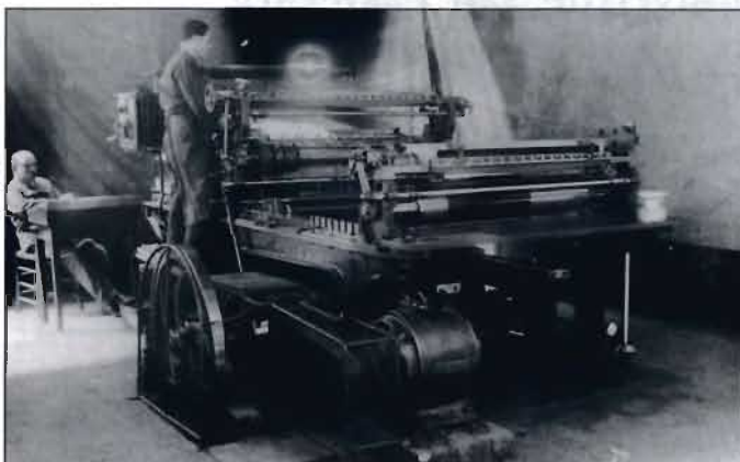
Presse en blanc, système Lambert (sur laquelle sont imprimées les feuilles de 300 TP).
