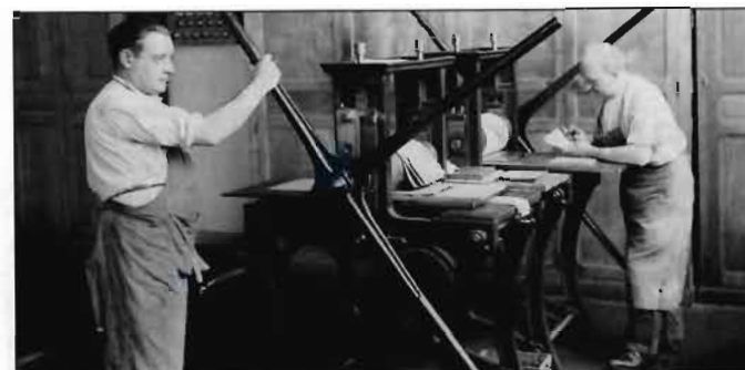
Atelier de fabrication des timbres-poste - Presse à bras pour épreuves de luxe.
