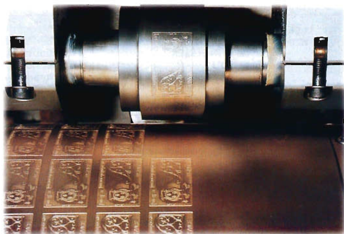
Le transfert du dessin sur le cylindre d'impression.
