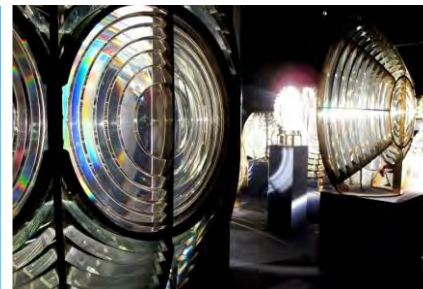
Des lentilles de verre à échelon, type Fresnel
