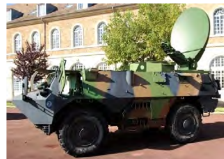
VAB ML - station de télécommunications mobile légère, par satellite, issue du programme Syracuse III
