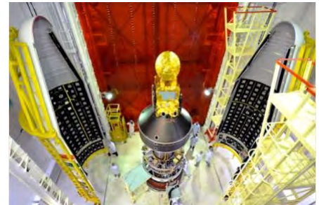
Intégration du satellite SARAL sur la lanceur PSLV20 © ISRO
