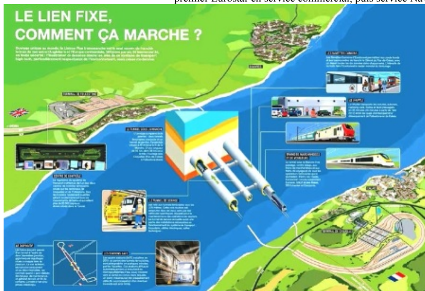
Tunnel sous la Manche : fonctionnement du lien fixe
