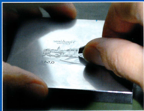
☒ Un gros plan du poinçon en acier doux
